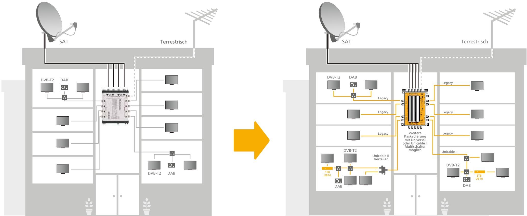
Vorhandene Multischalterinstallationen können durch zukunftssichere Unicable II™ Multischalter ersetzt oder erweitert werden. Dadurch wird es möglich, über ein einziges Koaxialkabel, mehrere Receiver / TV-Geräte mit einem Sat-Signal zu versorgen.
