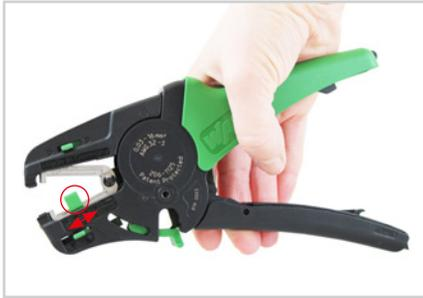
6.1 Längenpositionierer zusammendrücken und auf die gewünschte Abisolierlänge verschieben.
