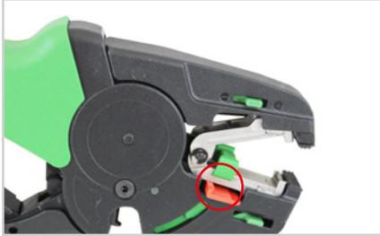
8.1 Austauschhilfe in die Aussparung unterhalb des unteren Messers einlegen (Pfeil auf Austauschhilfe unten liegend/kurzer Steg nach hinten) wie bildlich dargestellt.
