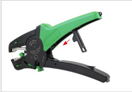
9.1 Feststeller an Lasche nach unten ziehen und Werkzeug schließen, bis sich der Feststeller in die Haltenase einfügen lässt. Den Feststeller am unteren Griff einhaken. Das Werkzeug bleibt nun geschlossen.
