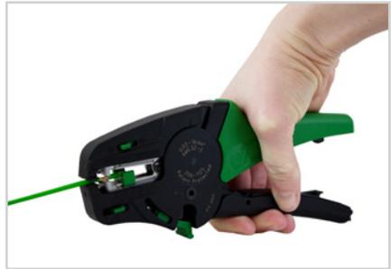
6.2 Leiter bis zum Anschlag in den Längenpositionierer einlegen.
