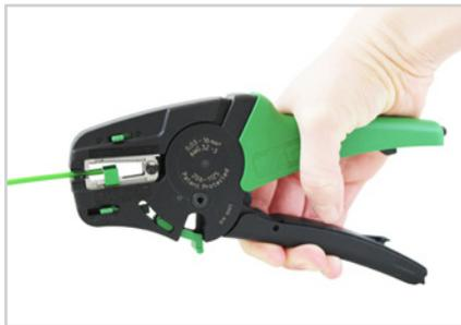
6.3 Werkzeug schließen, bis es automatisch wieder öffnet.
